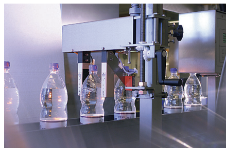
Inspection de bouteilles
